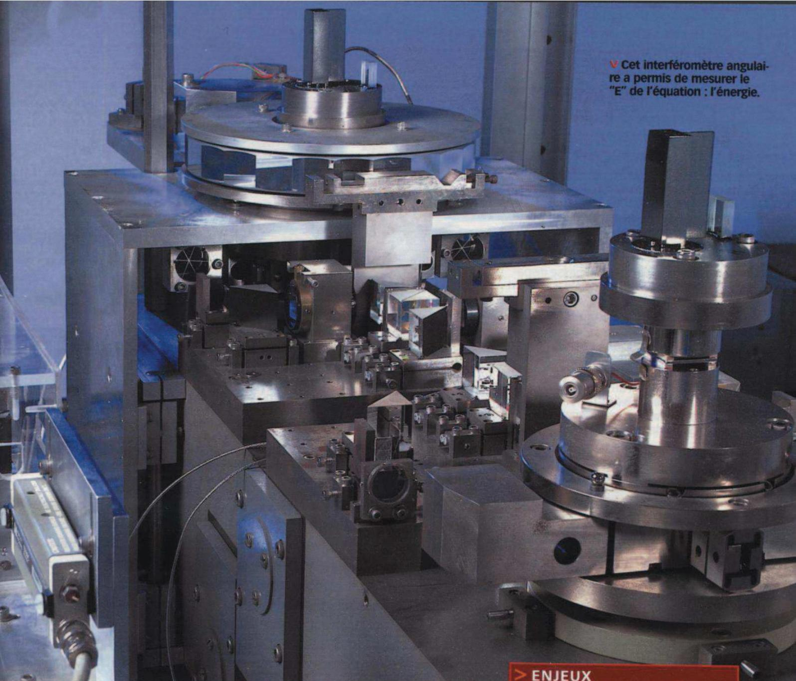
▼ Cet interféromètre angulaire a permis de mesurer le "E" de l'équation : l'énergie.
