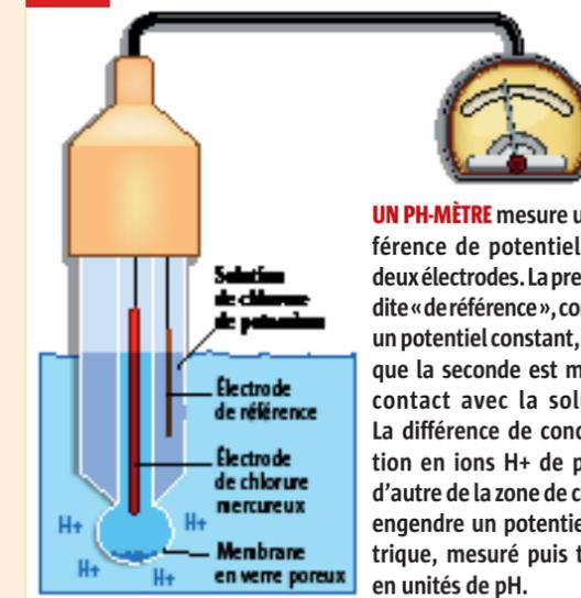
UN PH-MÈTRE mesure une différence de potentiel entre deux électrodes. La première, dite « de référence », conserve un potentiel constant, tandis que la seconde est mise en contact avec la solution. La différence de concentration en ions H<sup>+</sup> de part et d'autre de la zone de contact engendre un potentiel électrique, mesuré puis traduit en unités de pH.
