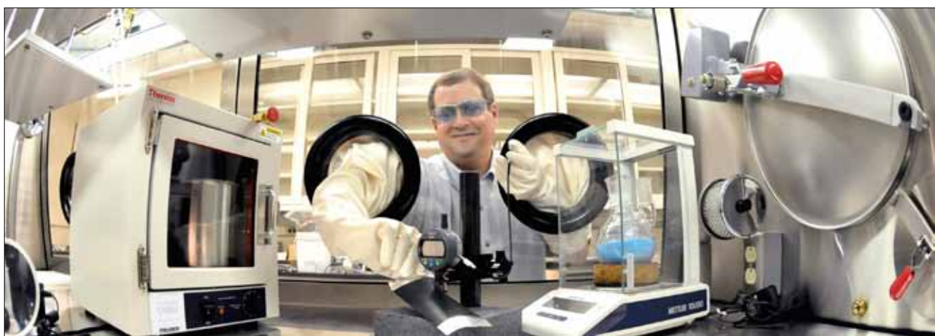
Christopher Johnson, de l'Argonne National Laboratory (Etats-Unis), teste une électrode positive dans laquelle le lithium a été remplacé par du sodium.
