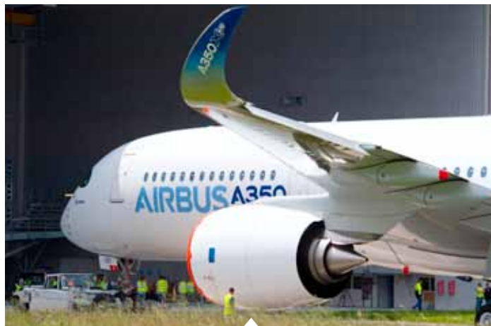
Les winglets à l'extrémité des ailes augmentent les performances.
