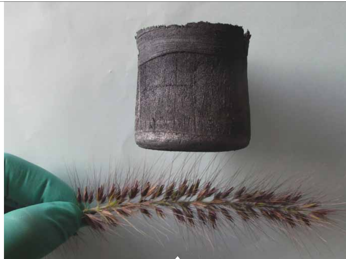
Ce matériau composé de carbone est le plus léger au monde : le bloc posé sur une graminée ne fait même pas plier les poils de l'extrémité de la plante.
