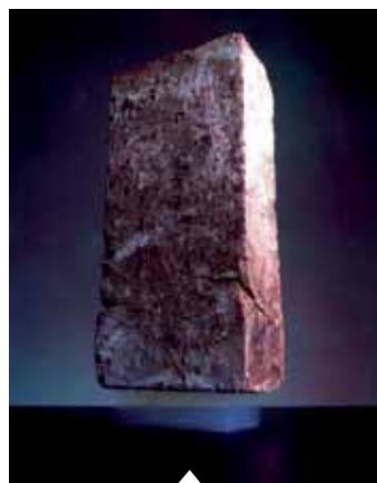
Robuste et isolant : un aérogel en silice peut soutenir une brique de 2,5 kg ou préserver une fleur de la destruction par une flamme intense.
