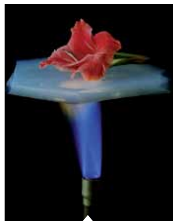
Robuste et isolant : un aérogel en silice peut soutenir une brique de 2,5 kg ou préserver une fleur de la destruction par une flamme intense.
