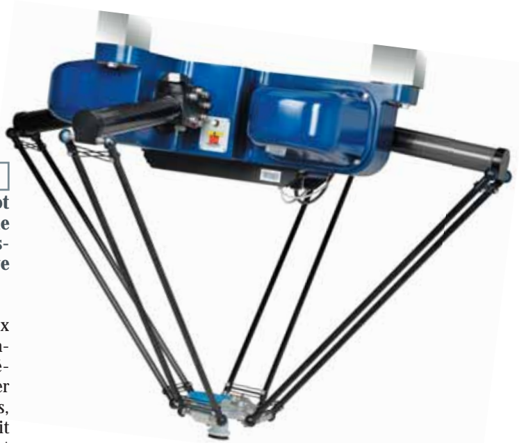
DES MOTEURS FIXES RELIÉS À QUATRE BRAS LÉGERS : cette conception permet à ce robot manipulateur d'être deux fois plus rapide et deux fois plus puissant que les dispositifs actuels © F. PIERROT/CNRS PHOTOTHÈQUE
