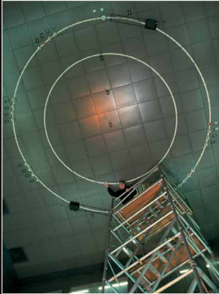
INSTALLÉ SUR UN ÉCHAFAUDAGE , le physicien installe des capteurs au plafond haut de 15 mètres du laboratoire d'étude des incendies de Siemens, près de Zurich. Au sol, le feu sera déclenché à la verticale du centre du cercle.
