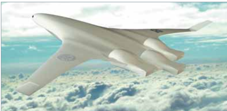
CE PROTOTYPE D'AILE VOLANTE a été construit dans l'optique de réaliser un avion gros porteur et vraiment silencieux, les nuisances sonores étant l'un des principaux freins au développement des transports aériens.
