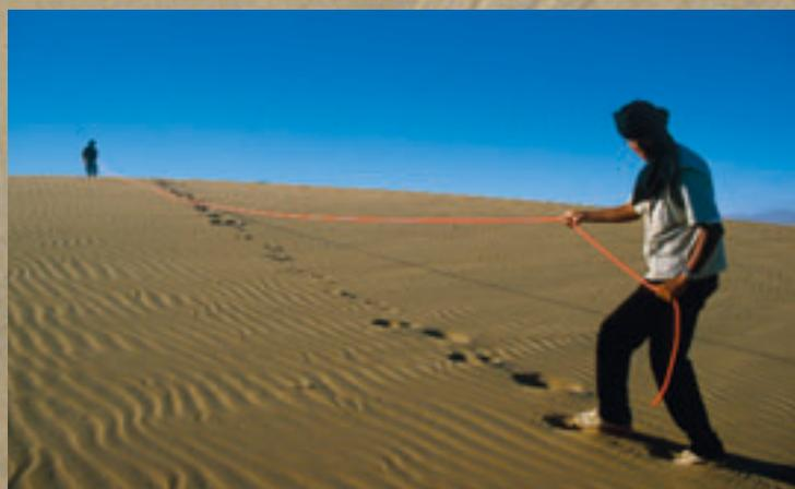
**UNE SIMPLE CORDE GRADUÉE DE PLUSIEURS MÈTRES** suffit pour mesurer la taille et la forme des dunes.
